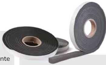
Mousse adhésive imprégnée expansible pour assurer l'étanchéité à la pluie battante (+ de 300kPa) de joint allant jusqu'à 10 mm
