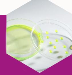
Les encres de test DYNE sont indispensables pour mesurer la tension de surface ou mouillabilité d'un support. Pour lire la mesure, une fois l'encre appliquée sur la surface, soit elle forme un film continu au moins 3 secondes, ce qui signifie que le support a une tension de surface minimum de la valeur de l'encre. Si l'encre se rétracte, alors la tension de surface du support est inférieure à celle indiquée sur le flacon.
