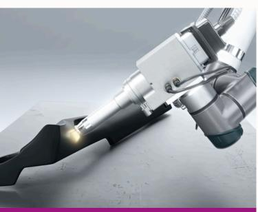
Ci-contre, la station SpinTEC30 avec têtes rotatives pour traiter des pièces jusqu'à 150 mm de large.
