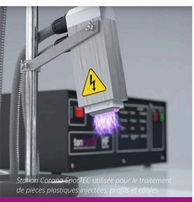
Traitement Corona Indirect: nos stations de traitement de surface Corona indirect sont simples d'utilisation et économiques. Elles ne nécessitent pas de contre- électrodes dans le process de fonctionnement. La haute tension alimente les deux électrodes qui se trouvent dans la tête de prétraitement. Ensuite, l'effluve est pulsé sur la surface du support grâce au flux d'air. Ceci permet de traiter tous les types de pièces très facilement notamment en 3D.
