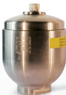
Corps en SS316, composé de deux parties assemblées au moyen d'un tuyau spécial qui, sous des pressions dynamiques, tend à se fermer. Divers matériaux de diaphragme disponibles, pour une large compatibilité chimique. Construit conformément à l'ASME VIII° Div. 1
