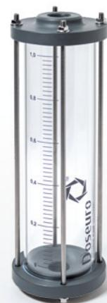
Le pot de calibrage est installé en dérivé sur la ligne d'aspiration de la pompe doseuse. Il se compose d'un cylindre avec une échelle graduée. Sa fonction est de déterminer le débit d'une pompe, en vérifiant le volume de liquide aspiré en un temps donné, dans ses conditions réelles d'utilisation.
