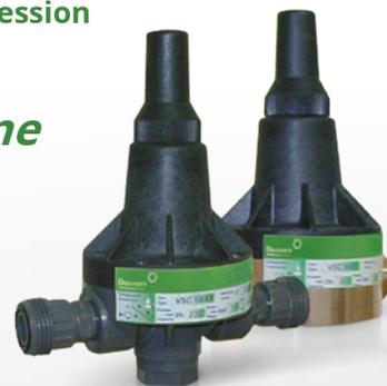
La soupape de contre-pression est installée en ligne sur le tuyau de refoulement de la pompe afin de contrer la pression existante dans l'aspiration afin d'éviter le siphonnage. L'utilisation de cette vanne permet de réguler le débit dans les cas où la pression de refoulement est faible ou inexistante.
