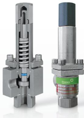
La soupape de sécurité est installée sur le tuyau de refoulement de la pompe et elle est reliée au tuyau de dérivation en tant que dispositif de sécurité, de sorte qu'elle s'ouvre (décharge) lorsque la valeur limite est atteinte afin de protéger le système et la pompe contre les surcharges de pression.
