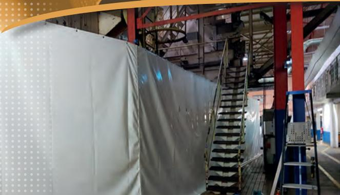
Cloison de séparation dans un atelier de fabrication
