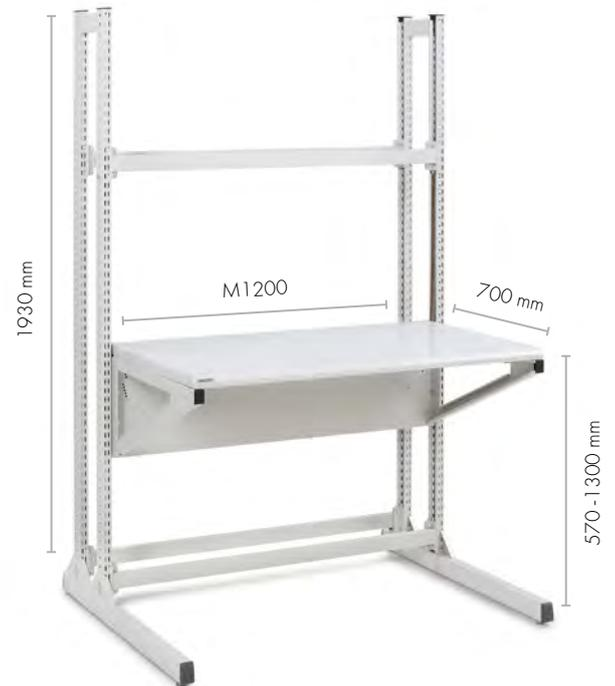
La solution de réglage en hauteur brevetée minimise la durée nécessaire à l'ajustement en hauteur requis lors de la manipulation d'articles variés. De plus, elle fluidifie les tâches quotidiennes, les rend plus efficaces et plus ergonomiques. Le plateau doit être ajusté en hauteur sans charge en raison du mécanisme d'ajustement par ressorts à force constante.
