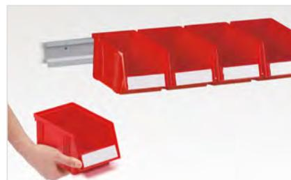
Rail porte-bac 700 pour bacs à bec et bacs distributeurs. Livré avec les vis de montage. La capacité de charge est d'environ 50 kg. Longueur 700 mm. Profilé en acier époxy émaillé gris. Bacs à bec 1015 - 1930 compatibles avec le rail. À commander séparément.
