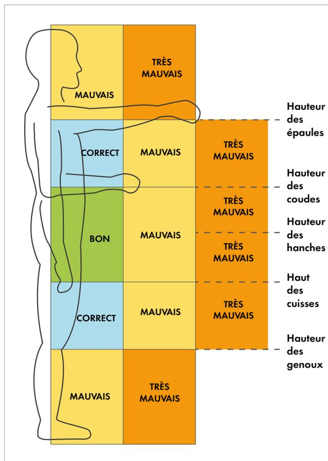
**Illustration des zones de préhension qui offrent la plus grande force et le plus de confort en termes de levage et de placement des charges, de poussée et de traction (c'est-à-dire au-dessus des genoux, sous les épaules, et près du corps).**
