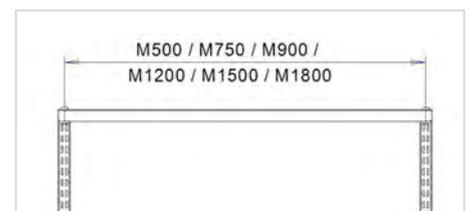
La dimension modulaire (M) se rapporte à la distance entre deux montants verticaux à partir du centre de ceux-ci. Cette dimension permet de choisir des accessoires adaptés.
