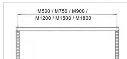
La dimension modulaire (M) se rapporte à la distance entre deux montants verticaux à partir du centre de ceux-ci. Cette dimension permet de choisir des accessoires adaptés.
