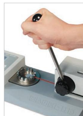
▲ Le levier ergonomique permet d'appliquer la force
