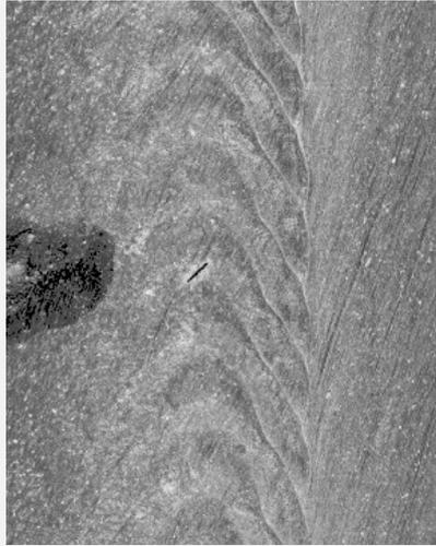
Contrôle de manque soudure sur des bonbonnes de gaz
