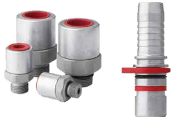
Les raccords encliquetables tournants WEO Plug-in sont équipés d'une butée à billes qui permettent la rotation du flexible hydraulique. Ils effectuent des rotations sur 360° et évitent les torsions des flexibles notamment dans des systèmes hydrauliques très compacts. Ils sont aussi simples et faciles d'utilisation que les autres produits de la gamme WEO mais acceptent en plus une rotation à pleine pression de service.
