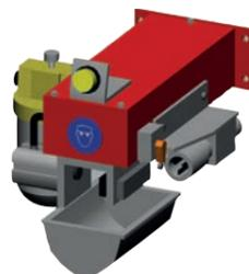
Tip Exchange System est un système permettant de changer les tubes contact en automatique. Ce système est composé d'un dispositif de retrait et de fixation de la buse de gaz, d'un magasin d'échange mécanique pour dix tubes contact, d'un capteur de surveillance et d'une unité de nettoyage rotative pour le nettoyage des tubes contact.
