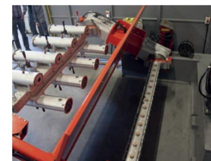
Positionneur triple axes « Barillet »
