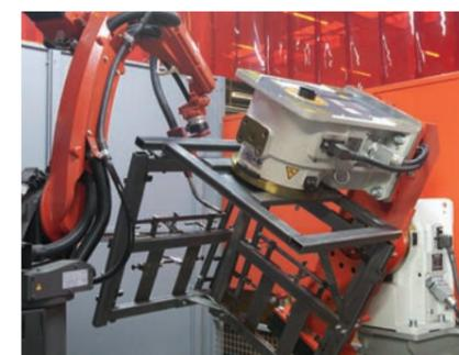
Positionneur double axe en L
