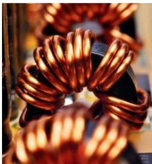
La mise en forme par frittage de NANOMAG-MnZn permet de réaliser des composants passifs magnétiques qu'on retrouve dans les inductances, les transformateurs et les convertisseurs.
