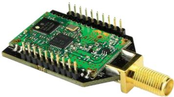
Le shield pour le module XBee™ vous permet d'intégrer facilement la technologie Sigfox ou LoRaWAN™ dans votre micro-ordinateur et de connecter votre appareil aux LPWAN.
