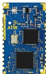
Ultra haute sensibilité : -141 dBm (SF12). Fonctionne à la fois sur LoRa P2P et LoRaWAN.
