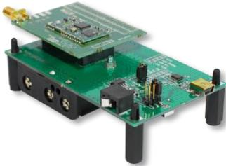
Ce SDK "Starter Development Kit" vous permettra de tester facilement la gamme de produits ATIM ARM-Nano. Le kit standard comprend une batterie et un connecteur USB.
