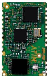
Même form facteur que la gamme de modules ARM, les modules N8-LP et N8-LD sont optimisés pour une communication en mode local en 868 MHz.
