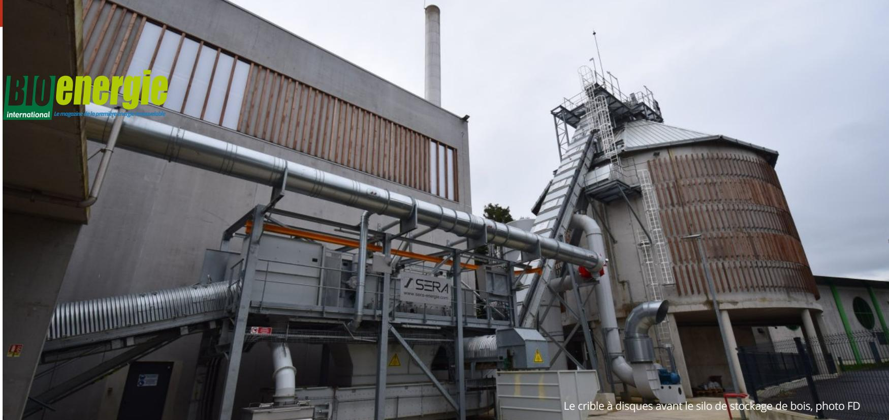
Le crible à disques avant le silo de stockage de bois, photo FD
