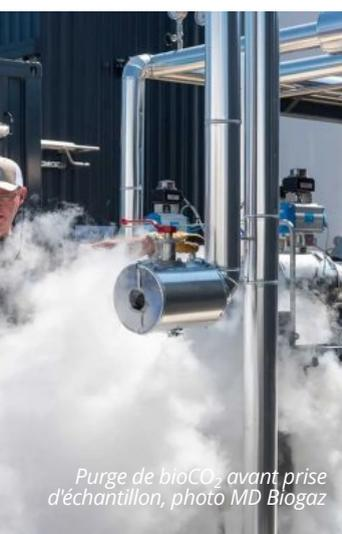
Purge de bioCO<sub>2</sub> avant prise d'échantillon, photo MD Biogaz
