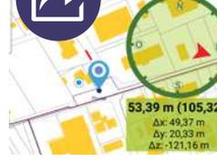
Données terrain sauvegardées en format AGI (xml) et directement exploitables par le logiciel bureau ArpentGIS®-Expert et exportables vers tout logiciel SIG ou DAO (ArcGIS, QGIS, AutoCAD, ...)
