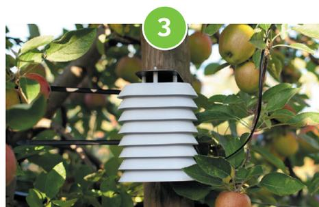
Abri avec capteurs de température et d'hygrométrie
