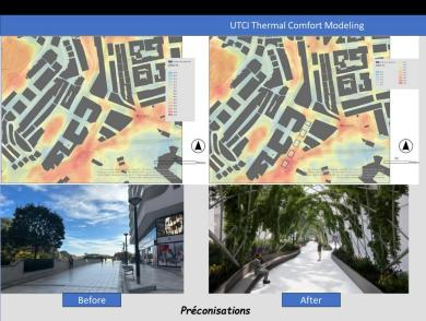
Il est constaté que grâce à l'apport des pergolas végétalisées, un confort thermique jusqu'à 2,4°C UTCI est apporté au niveau des aménagements (de la partie centre et nord notamment). En revanche, cette solution de rafraichissement urbain a un effet très localisé. En effet, on constate qu'en l'espace de 10 mètres, entre un espace ombragé par les pergolas et un espace qui ne bénéficie pas de cet solution, l'inconfort est augmenté de 2,2°C UTCI.
