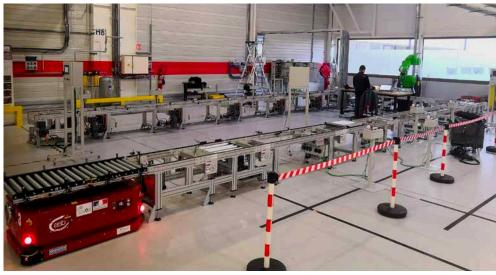
ligne sur-mesure de convoyeurs usine du futur 4.0 robotisation, convoyage et raccordement AGV étudiée et fabriquée en France, livrée et mise en service sur site en France
