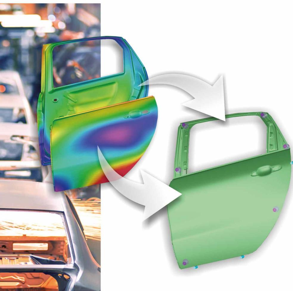
de la géométrie pourra quant à lui compenser le retour élastique d'un ensemble assemblé (compensation sur la pièce menante par exemple, puis assemblage pièce menante et menées pour analyse du résultat sur l'assemblage).
