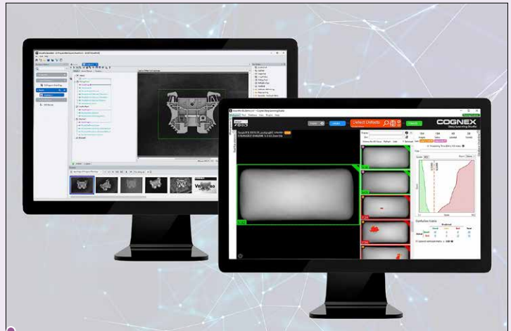
→ VisionPro Deep Learning 2.0 s'intègre à VisionPro 10.0 afin d'associer au sein de la même application les outils d'apprentissage profond (Deep Learning) et les outils de vision traditionnels.
