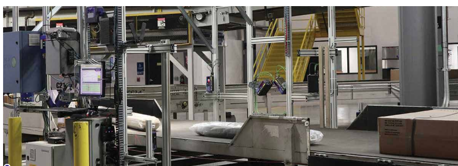
↳ Le système MFDS de Datalogic combine plusieurs technologies de détection, de lecture de données et de capture d'images pour assurer la traçabilité des colis défilant automatiquement sur des convoyeurs.
