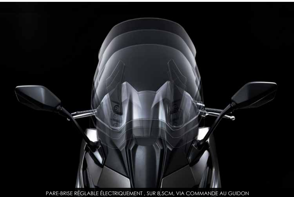
PARE-BRISE RÉGLABLE ÉLECTRIQUEMENT, SUR 8,5CM, VIA COMMANDE AU GUIDON
