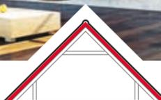
Isolation des toitures par l'extérieur (sarking)
