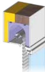
Le coffre tunnel Act'O 1/2 linteau d'Atlantem réunit tous les avantages d'un coffre tunnel (il ne se voit pas) et permet de poser la menuiserie avec son volet en une seule fois.
