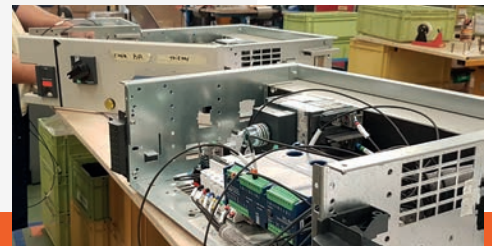
Assemblage et câblage de platines électriques
