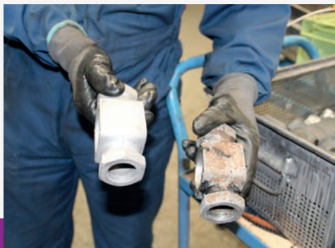
Maintenance de robinets pneumatiques
