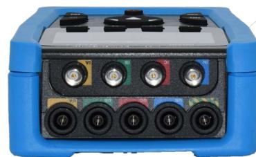
Entrées capteurs de courant et tension
