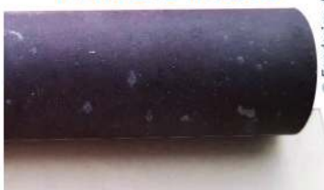
Echantillon de corrosion après 129h d'exposition à l'air + CO 2 + SO 2 à 850°C
