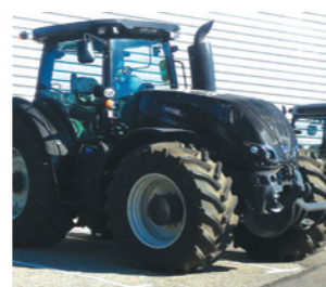
Client AGCO Pièces en moulage infusion pour capot carrosserie tracteur Valtra (Réalisation site de St-Geoirs)
