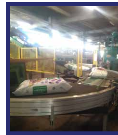
Mise en place d'un convoyeur accessible pour faciliter la prise de sacs et les contrôles soudure
