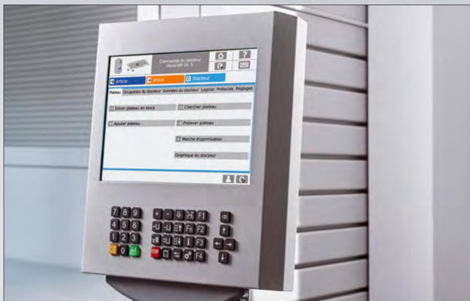
L'écran tactile 12 pouces de la nouvelle commande Hänel MP 14 N procure un confort d'utilisation maximal. Même quand il affiche le clavier, l'écran offre encore largement assez d'espace pour représenter les informations
