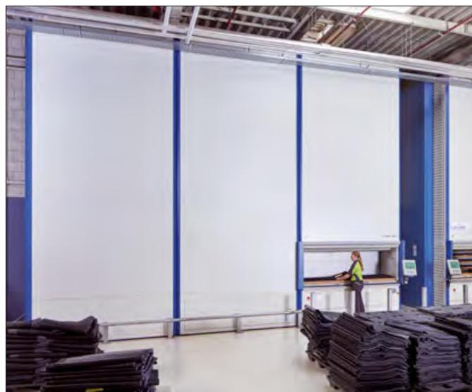
Les déplacements horizontaux et verticaux s'effectuant en même temps, le produit stocké dans le Hänel Multi-Space® est mis à disposition par le chemin le plus rapide
