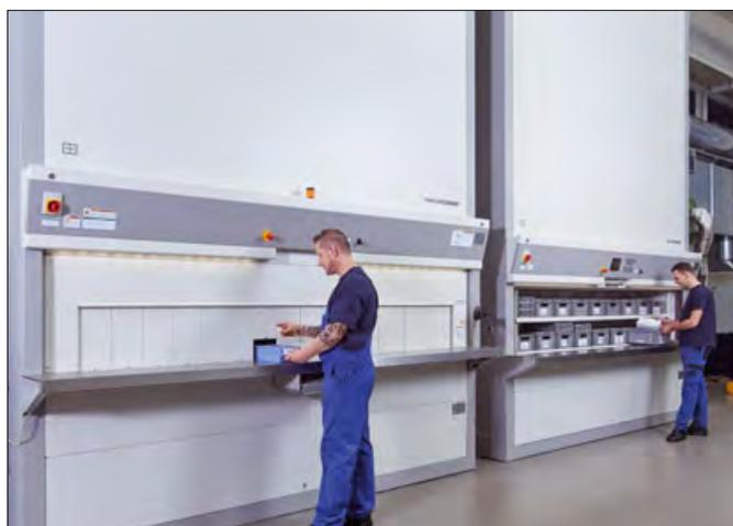
Avec ses solutions d'intralogistique, Hänel permet aux petites et moyennes entreprises de rationaliser leur stockage à moindre coût. Un Hänel Lockomat® et un Hänel Rotomat® servant au stockage d'outils
