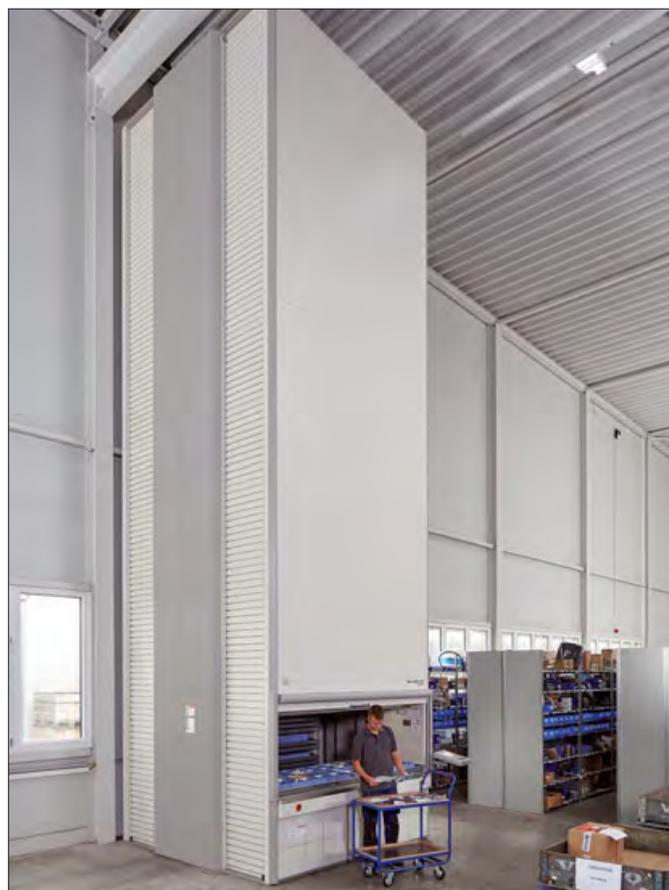
Avec une hauteur supérieure à neuf mètres, ce Hänel Lean-Lift® offre une énorme capacité de stockage, et nous avons gagné beaucoup de surface au sol
