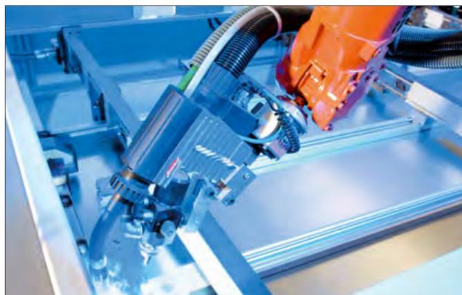
**Installation de soudage entièrement automatisée conçue spécialement pour Hänel**
