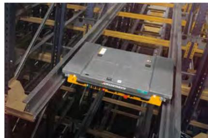
Navettes de stockage compactes UPC (jusqu'à 1500 kg)
