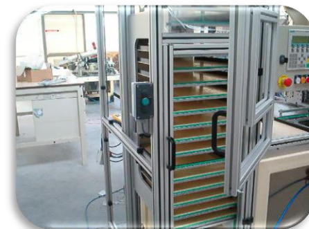
Magasins automatiques blisters
