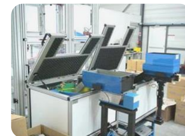
Alimentation par bols vibrants insonorisés et trémies
