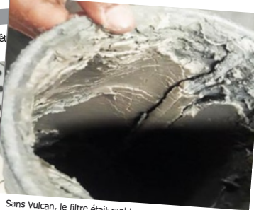
Sans Vulcan, le filtre était rapidement obstrué par les dépôts de calcaire et il devait être remplacé toutes les 48 heures.
