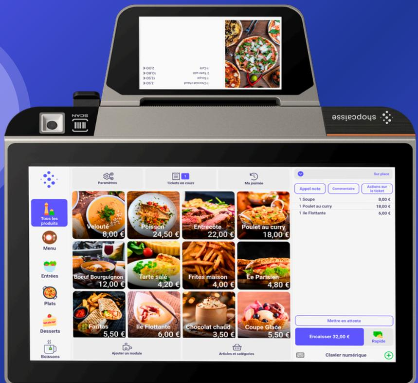
Ecran tactile IPS 10,1" HD 1280 x 800 10,1", Dim. 250\*213\*91mm ou 250\*231\*108mm, Imprimante intégrée: 58 ou 80 mm, afficheur client (2 ou 4"), Luminosité 300cd, Connexions USB (type A, 3x), Bluetooth (BLE, classe 5.0), Ethernet, WiFi (802.11ac), Connecteur tiroir-caisse (RJ11, RJ12), NFC, Qualcomm Hexa-Core, 1,9 GHz, Mémoire RAM: 3 Go, flash: 32 GB, Android (13). Visuels non contractuels.
