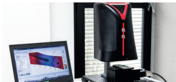
L'appareil **Polymap** permet la mesure de microreliefs et la caractérisation des rugosités submicroniques sur de petites surfaces
