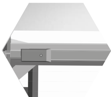
LED protégée par profilé en aluminium et son couvercle diffuseur et protecteur.
