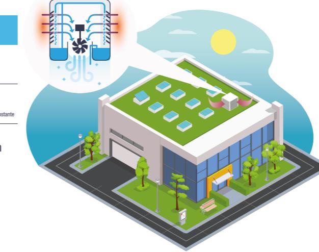
Le module adiabatique se met intégralement en fonctionnement (ventilateur et pompe à eau) et transforme l'air extérieur, chaud et sec, en un air plus frais et humide pour permettre d'abaisser la température intérieure du bâtiment. Un lanterneau ouvert permet d'évacuer l'excès de chaleur et d'humidité.
