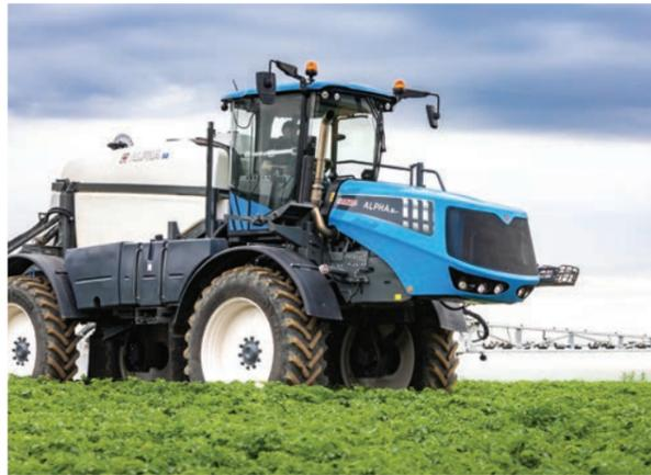
La conception et la disposition des différents organes (moteur, cuves, réservoirs...) sont spécialement étudiés pour optimiser la répartition des charges entre les essieux avant et arrière, ce qui garantit à l'ALPHA R-Activ une meilleure motricité et un meilleur franchissement dans les pentes tout en préservant la structure des sols.
