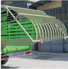
Ouverture hydraulique de la porte
