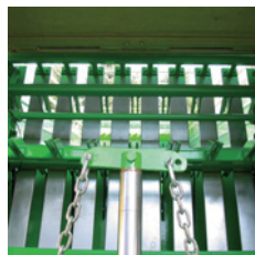
Échelle autochargeuse L: 1400 - 8/9/10 ameneurs avec déchargement assisté. Prédiposition 9 coupeaux hacheurs
