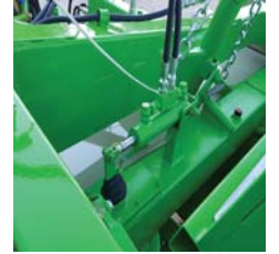
Débrayage avec vérin hydraulique
