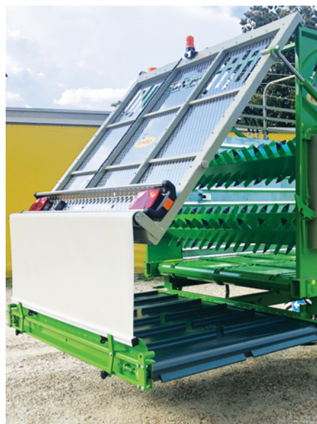
DÉCHARGEMENT LATÉRAL À ROULEAUX DE DOSAGE AVEC TAPIS DE DÉCHARGEMENT LATÉRALE RÉTRACTABLE HYDRAULIQUEMENT
