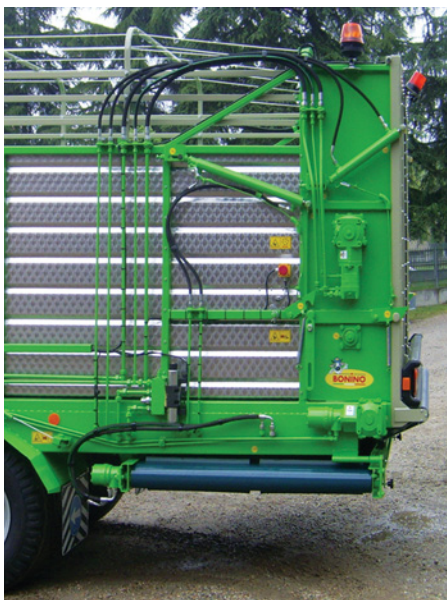
DÉCHARGEMENT LATÉRAL À ROULEAUX DE DOSAGE AVEC TAPIS DE DÉCHARGEMENT LATÉRALE RÉTRACTABLE HYDRAULIQUEMENT
