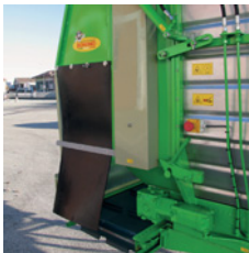
Déchargement latéral à rouleaux Rouleaux de dosage
