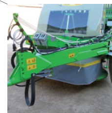
Timon double châssis renforcé
