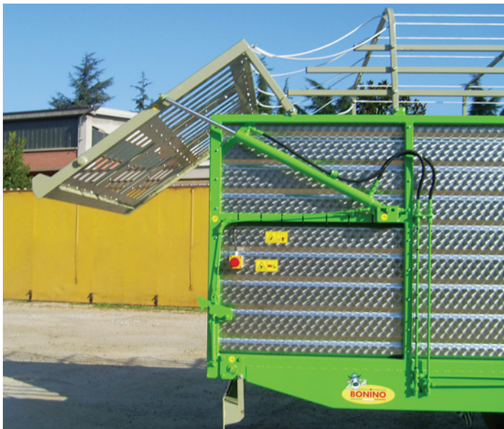
OUVERTURE HYDRAULIQUE DE LA PORTE
