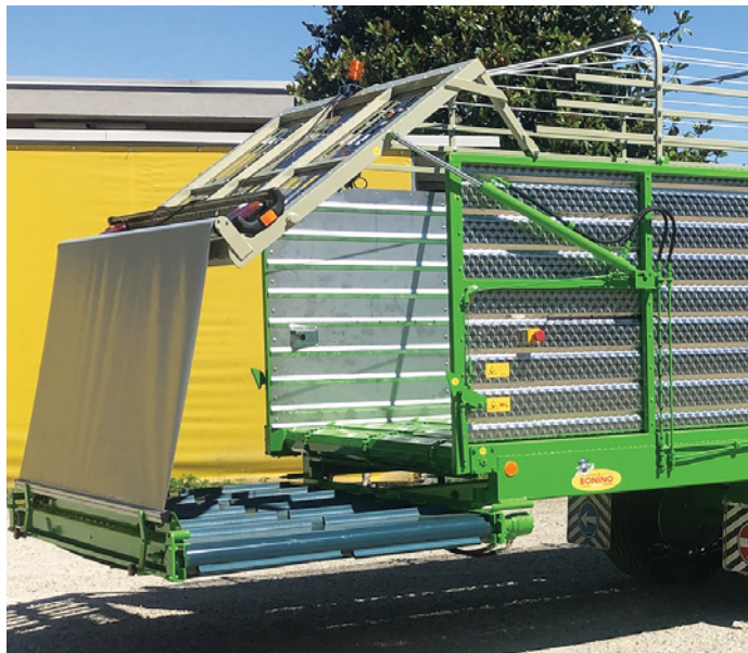
TAPIS DE DÉCHARGEMENT LATÉRAL RÉTRACTABLE HYDRAULIQUEMENT
