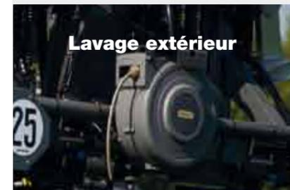
Optionnel, il permet de laver l'appareil au champs à l'aide d'un enrouleur automatique avec 18 mètres de tuyaux ainsi qu'un pistolet et un balai-brosse.
