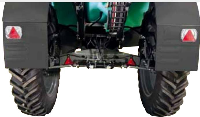
*L'option essieu suiveur permet au pulvérisateur de passer dans les roues du tracteur. Utilisable en mode automatique, il reste aussi pilotable manuellement pour une manœuvre d'évitement ou une utilisation en dévers.*
