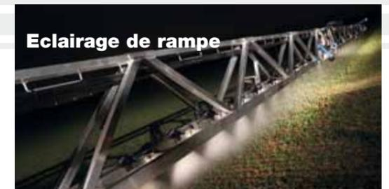
Le pack éclairage peut équiper l'appareil. Il est constitué, pour les rampes jusqu'à 33 m d'1 feu au poste de mise en oeuvre et de 2 feux sur la rampe alors que 4 feux équipent les rampes au-delà de 33 m
