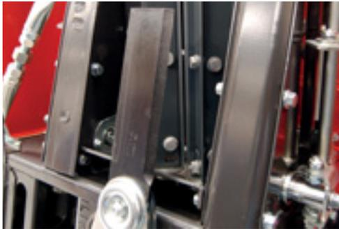
Convoie les tiges au broyeur.
