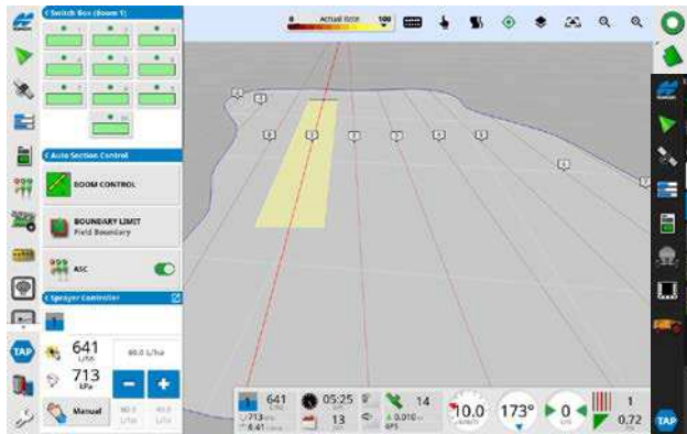
Horizon OS ex : contrôle automatique de sections
