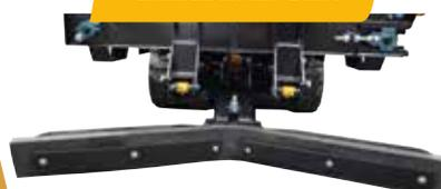
Lame de raclage en V, hauteur 140mm, bande armurite ép. 30mm, relevage hydraulique simple effet indépendant
