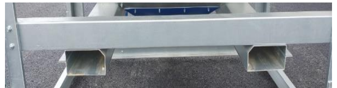
Fourreaux de déplacement
