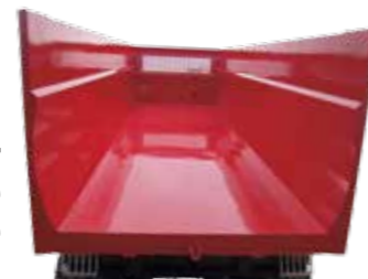
Côtés en tôle acier pliée d'une seule pièce
