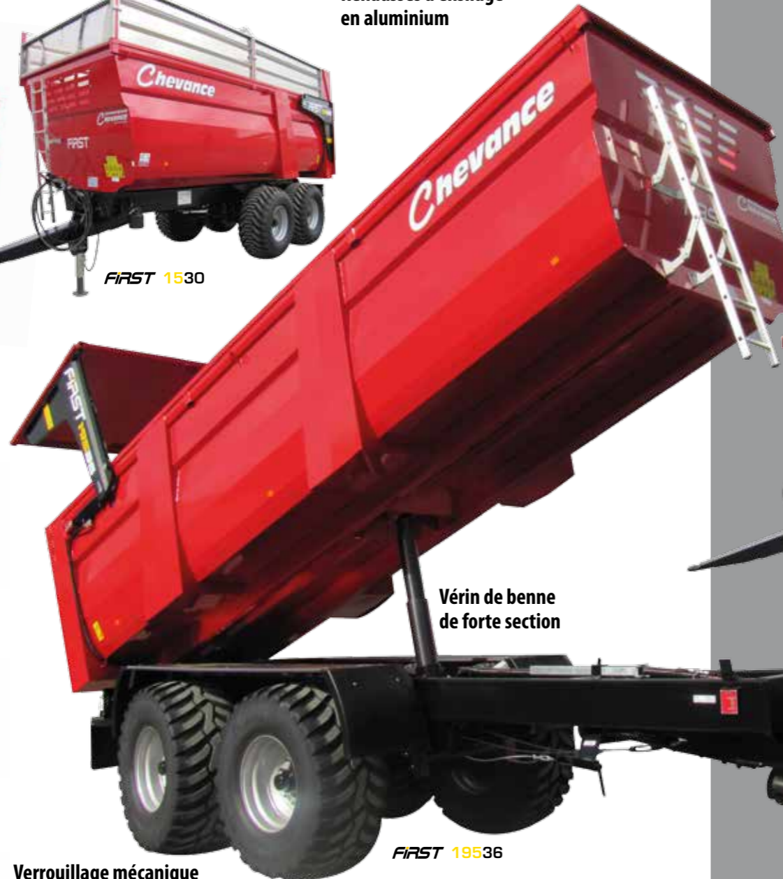
Côtés en tôle acier pliée d'une seule pièce
