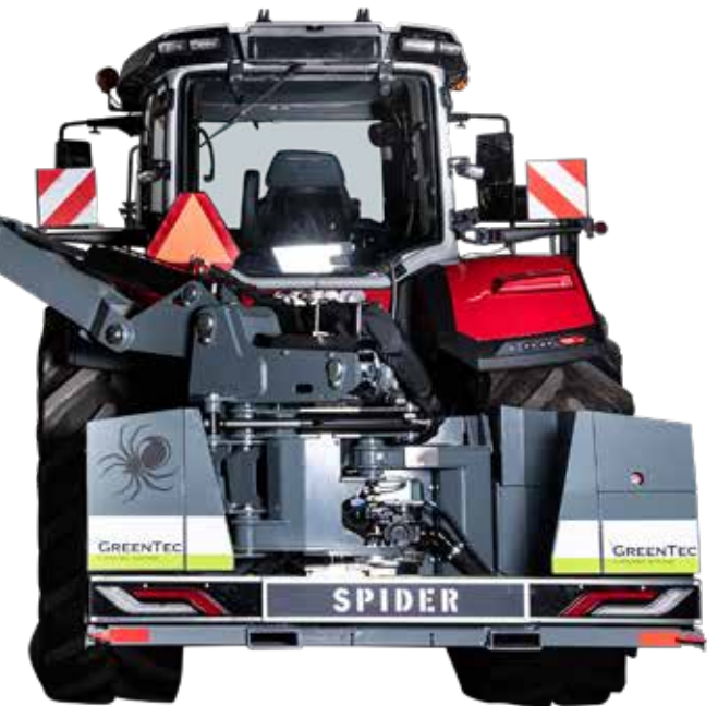
Le bras est commandé à partir de la cabine et peut être déplacé de droite à gauche et dans le champ de vision du conducteur.
