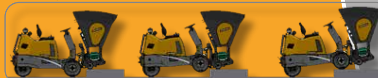
2 roues Ø 200 pour passage de marche (marche jusqu'à 20cm)
