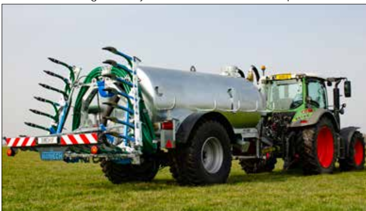
Attelage avec système Bomech à raccord rapide et universel
