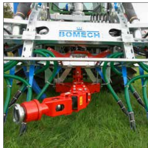
Système d'accouplement sans tonne
