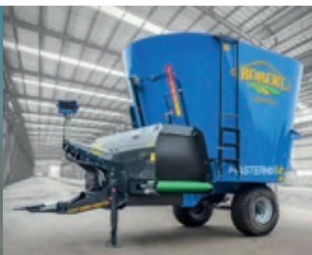
MASTERMIX 2-17T (17 M 3 ) Distribution: Déchargement par tapis Distribution type: Unloading via the conveyor Distributie: Ontladen via transportband
