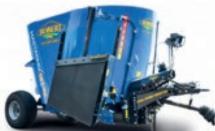
MASTERMIX SB 1-7P (7 M 3 ) Distribution: Déchargement par porte Distribution type: Unloading via the door Distributie: Ontladen langs deur
