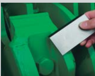
Rotor à couteaux à changement rapide affûttables et réglables
