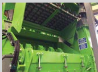
Double grille de calibrage permettant d'augmenter la surface de calibrage (en option).
