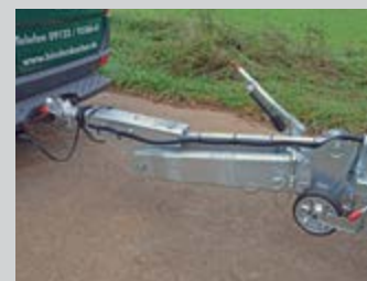
Barre d'attelage réglable en hauteur pour anneau d'attelage ou boule de remorque
