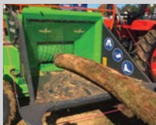
Système d'alimentation puissant : rouleau Ø 400 mm et tapis ameneur en acier à dents d'entraînement soudées.
