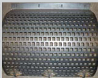
Grilles de calibrage disponibles : 25/25 mm, 35/40 mm, 50/50 mm
