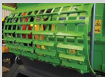
Grille avec déflecteurs : 45/60 mm, 60/80 mm, 80/80 mm
