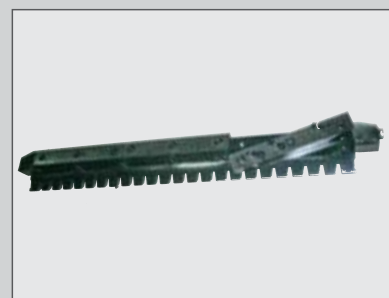
Contre-couteau modulaire renforcé par des pastilles de carbure de tungstène, retournable 1 fois : durée de vie x 8
