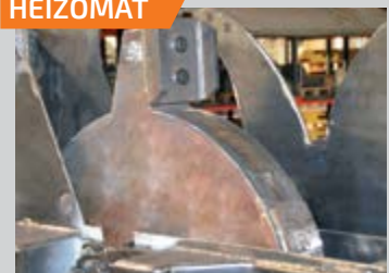
Soufflerie à volant d'inertie d'1 T = réserve de puissance ⊖ conso, ⊖ régul, ⊖ sollicitation moteur et rotor ⊕ puissance/force, ⊕ régularité
