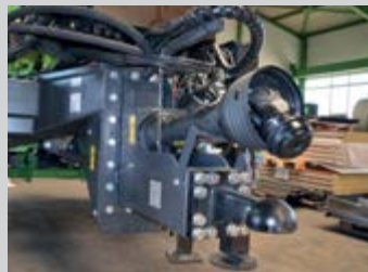
Hauteur d'attelage ajustable 500, 600, 900 ou 1000 mm
