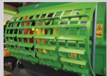
Grilles de calibrage changeables très facilement : 25/25 mm, 35/40 mm, 45/60 mm, 60/80 mm, 80/80 mm
