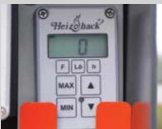
Système de commande no-stress (idem gros broyeurs) pour réguler l'avancée du bois à déchiqeter
