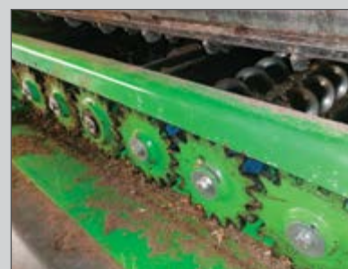
Vis de nettoyage sous la table d'alimentation (selon broyeur)
