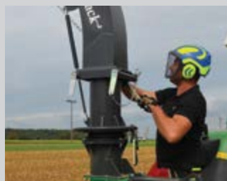
Goulotte orientable manuellement et casquette d'éjection réglable de série.
