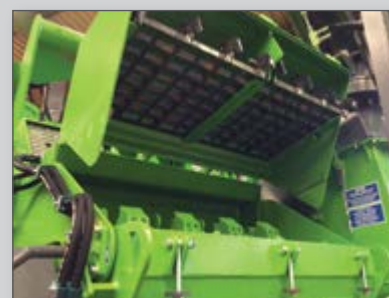
Double grille de calibrage : surface de calibrage x 3,5
