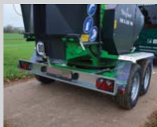
Châssis routier 80 km/h + barre de protection
