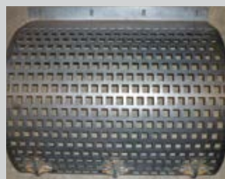
Grilles de calibrage disponibles : 25/25 mm, 35/40 mm, 50/50 mm
