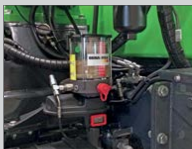
Lubrification automatique centralisée facile et rapide d'utilisation
