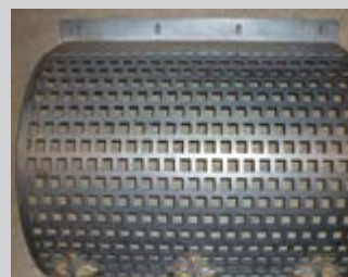
Grilles de calibrage disponibles : 25/25 mm, 35/40 mm, 45/60 mm, 60/80 mm
