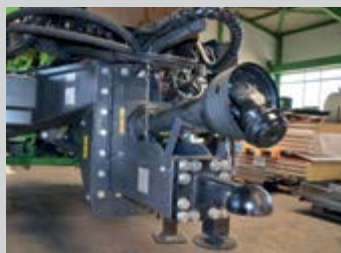
Hauteur d'attelage ajustable 500, 600, 900 ou 1000 mm
