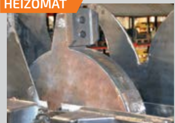
Soufflerie à volant d'inertie d'1 T = réserve de puissance ⊖ conso, ⊖ régl, ⊖ sollicitation moteur et rotor ⊕ puissance/force, ⊕ régularité
