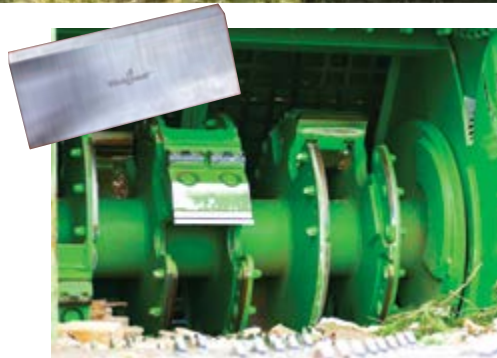
Rotor 6 couteaux 200 mm / 90 mm
