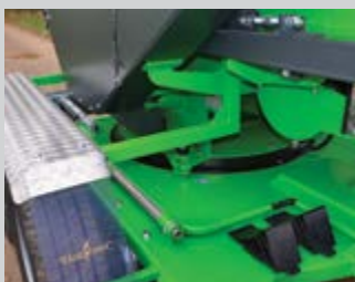
Plateau tournant à 270° pour orienter le broyeur selon le chantier.
