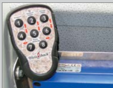
Télécommande radiocommandé pilotage de la goulotte d'éjection
