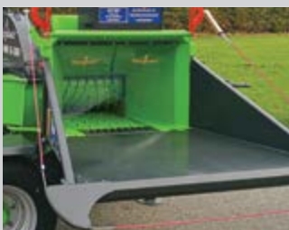
Système d'alimentation puissant à vitesse réglable. (rouleau et tapis ameneur en acier à dents d'entraînement soudées).
