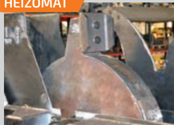
Soufflerie à volant d'inertie d'1 T = réserve de puissance ⊖conso, ⊖régul, ⊖solllicitation moteur et rotor ⊕puissance/force, ⊕régularité
