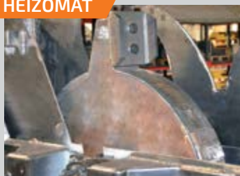
Soufflerie à volant d'inertie d'1 T = réserve de puissance ⊖ conso, ⊖ régl., ⊖ sollicitation moteur et rotor ⊕ puissance/force, ⊕ régularité
