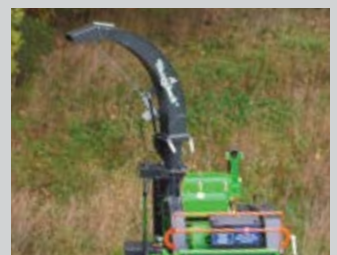
Tourelle et casquette hydro-electrique orientable et ajustable de série
