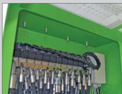
Bloc hydraulique avec levier pour fonctionnement manuel
