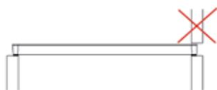
Posez les extrémités dans le mortier. Ne pas serrez les extrémités.
