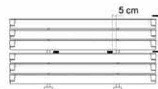
Max. 5 cm entre les fourches du chariot élévateur et les bois. Soulevez au maximum 1 pile à la fois avec les fourches.
