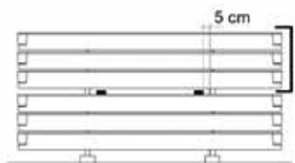
Max. 5 cm entre les fourches du chariot élévateur et les bois. Soulevez au maximum 1 pile à la fois avec les fourches.
