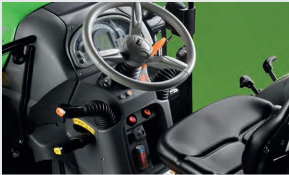
Disposition ergonomique des leviers de vitesse.
