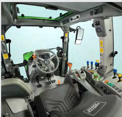
↑ L'équipement de cabine MaxiVision à distributeurs arrière entièrement mécaniques est disponible pour les modèles Powershift et RCshift.
