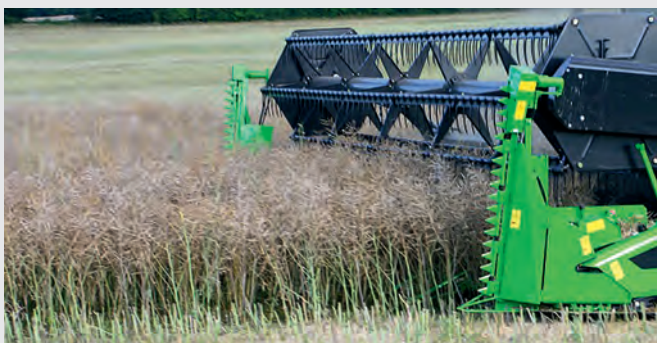
↑ Un kit spécialement conçu pour le colza a été mis au point, qui s'applique à toutes les barres de coupe DEUTZ-FAHR standard jusqu'à 7,2 m.
