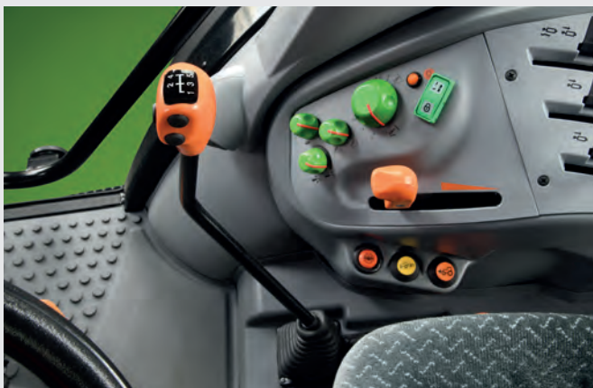
↑ Relevage arrière électronique avec système d'amortissement des vibrations.
