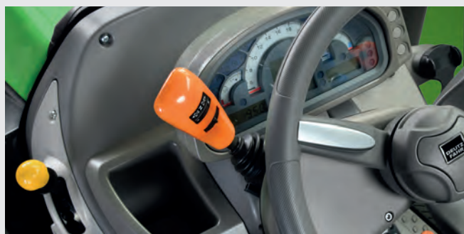
↑ Inverseur hydraulique avec SenseClutch.
