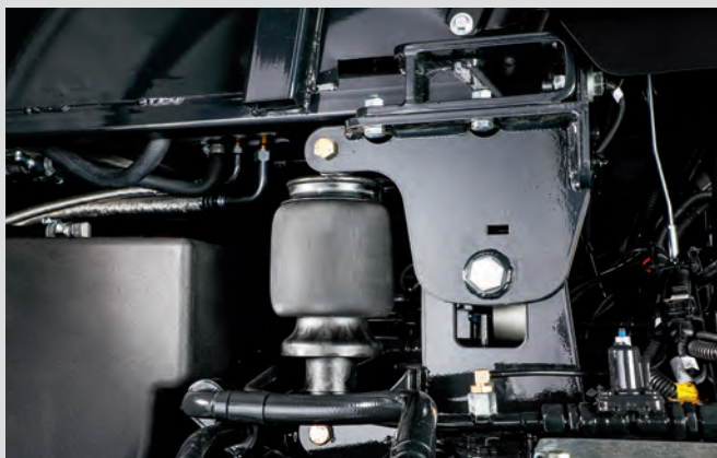
Le 8280 TTV peut être équipé de suspension de cabine pneumatique.
