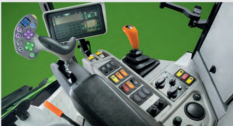
👉 Cabine moderne avec nouveau tableau de bord et colonne de direction réglable sur trois positions.
