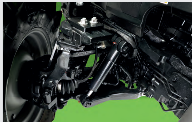
Suspension de pont avant à roues indépendantes.
