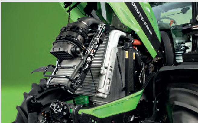
↑ Système de refroidissement en aluminium 6210 TTV, 6230 TTV et 6230 TTV HD avec levier d'accès à une main et filtre à air Powercore.
