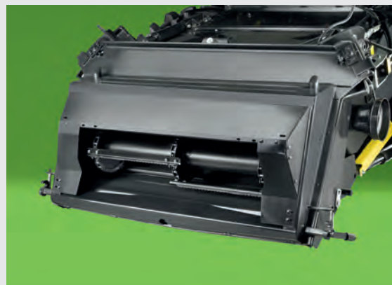
↑ Grâce à la largeur considérable du convoyeur, le battage n'est pas limité en cas de grandes quantités de grain.
