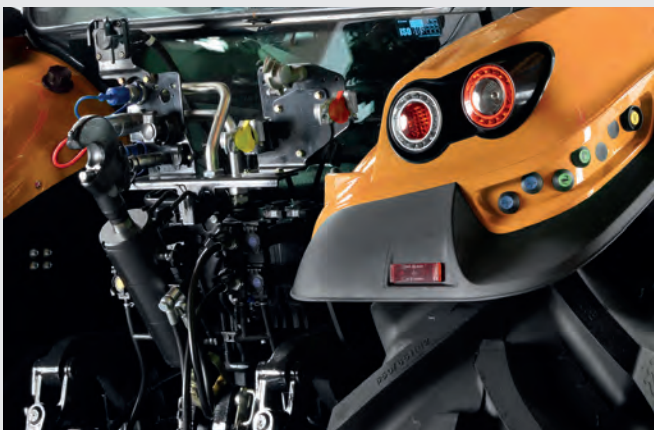
↑ Le système de freinage pneumatique ralentit les remorques dans toutes les catégories de poids de manière fiable et sûre.
