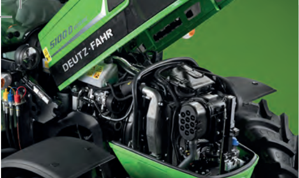
➤ Radiateur compact avec ventilateur à viscoupleur et filtre à air PowerCore pour une efficacité maximale du moteur.
