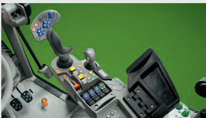
↑ Accoudoir MaxCom avec joystick ergonomique et fonctions clairement codées par couleur.
