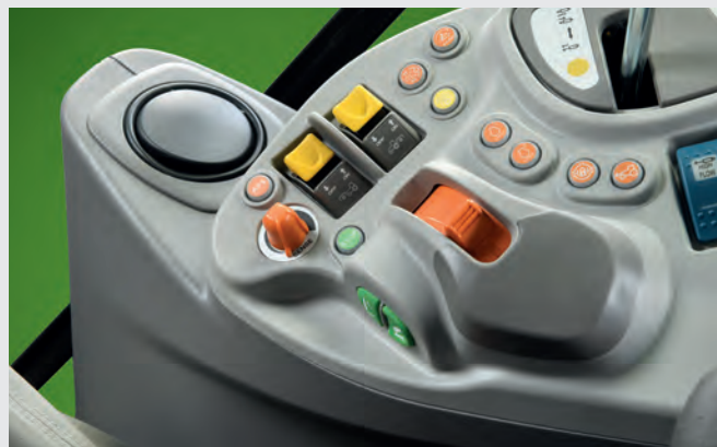
PDF avant et arrière à engagement électrohydraulique et fonction AUTO PTO.
