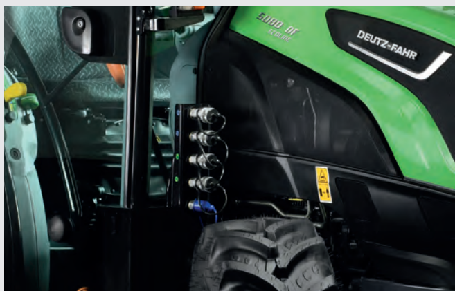
➤ Jusqu'à 4 voies hydrauliques dupliquées de l'arrière et 1 retour libre.
