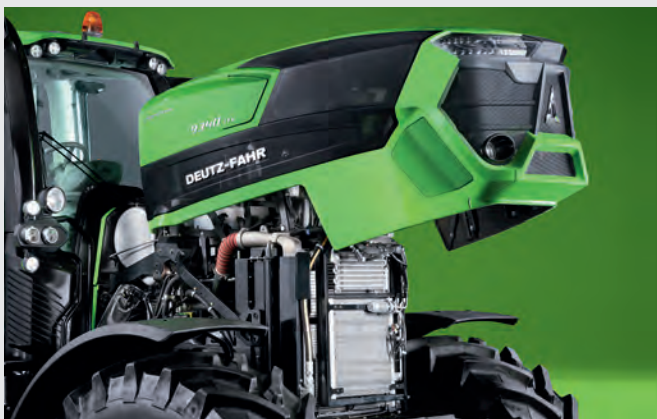
Un capot à ouverture électrique facilite les travaux d'entretien.
