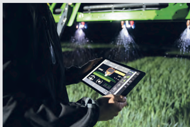
↑ Fonction XTEND avec tablette, contrôle des outils via ISOBUS UT tout en étant hors de la cabine.
