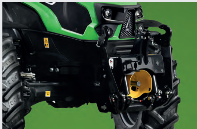
↑ Sur demande, les modèles 5D peuvent être équipés de relevage avant et de PDF avant.
