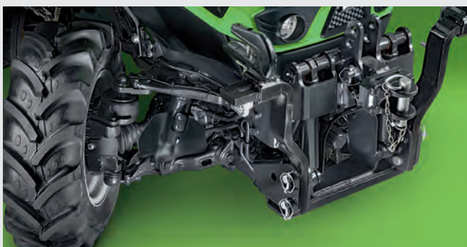
↑ Suspension de pont avant indépendante.
