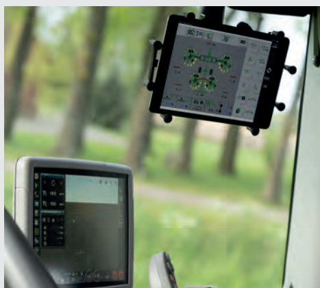
XTEND permet d'afficher sur une tablette SDF Guidance ou de contrôler un outil ISOBUS.
