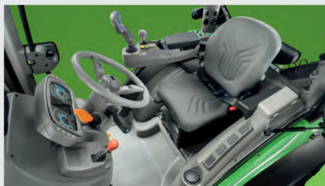
↑ Cabine spacieuse à 4 montants avec plancher entièrement plat grâce à la transmission TTV compacte basse.
