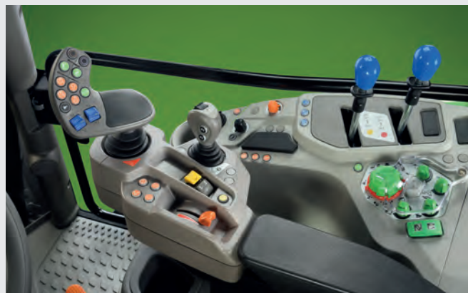
Accoudoir satellite TTV avec joystick MaxCom.
