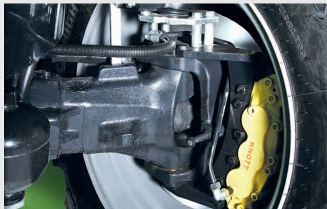
60 km/h et puissance maximale de freinage avec freins à disque secs extérieurs.
