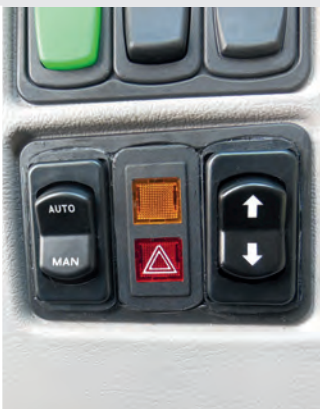
➤ Contrôle indépendant entre le système BALANCE avant et de mise à niveau arrière, chacun à fonction automatique ou manuelle.
