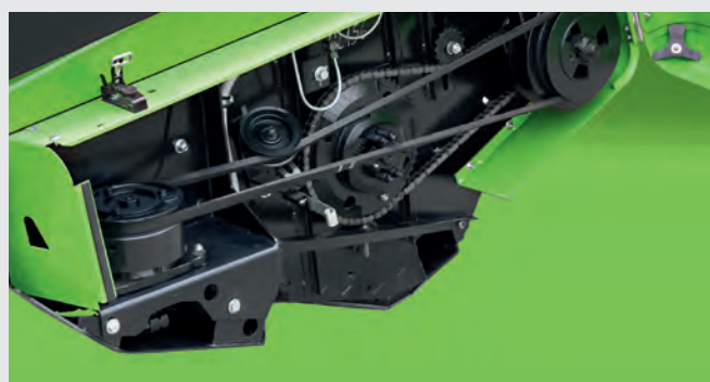
↑ Engrenage épicycloïdal à 1 220 tr/min pour une fréquence de coupe élevée.
