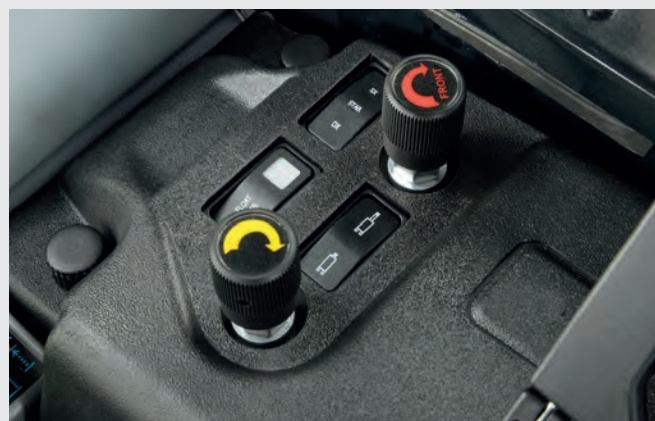
➤ Deux régulateurs de débit.
