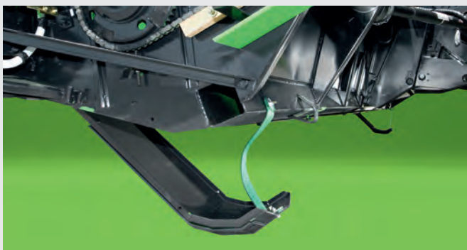
↑ De robustes plaques de protection intègrent les capteurs au sol pour contrôler la position de la barre de coupe, même sur terrains irréguliers.
