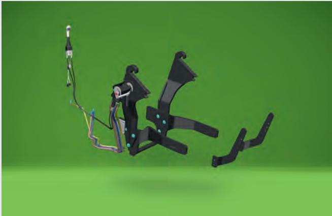
↑ Avec le Ready Kit, les interfaces pour chargeur frontal sont déjà montées sur le tracteur.
