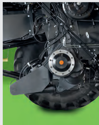
➤ Les ponts d'une capacité de 25 t permettent à la machine d'évoluer dans les conditions les plus extrêmes, tout en garantissant une fiabilité maximale et, surtout, la sécurité du conducteur.
