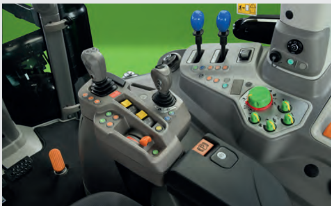
↑ Cabine MaxiVision + avec commandes des distributeurs arrières mixtes et gestion du chargeur électronique.
