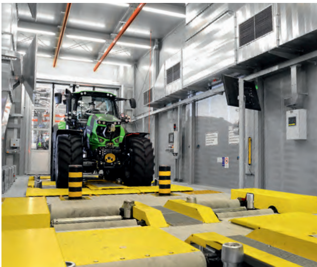
➤ Lauingen, Allemagne : unique dans la production de tracteurs : les dynamomètres de pont et de châssis.
