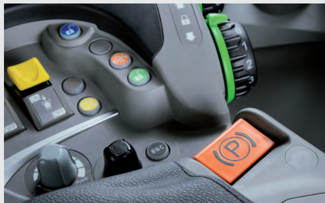
Frein de stationnement électronique (EPB) intégré à l'accodoir MaxCom.
