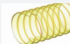
**Structure:** Gaine flexible faite d'une paroi polyuréthane polyester souple, renforcée d'une spirale en acier ressort cuivrée pour une mise à la terre. Sans halogènes et sans plastifiants. FLEXX PU 04 IND: Paroi 0,4mm, FLEXX PU 06 IND: Paroi 0,6mm.
