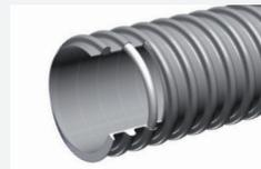
**Structure:** Gaine flexible de poids moyen, faite d'une paroi en PVC souple renforcée d'une spirale en PVC rigide de qualité antichoc. Surface intérieure très lisse. PVC classé au feu selon la norme UL94 V0 (en fonction de l'épaisseur de matière – nous consulter).
