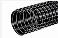
**Structure:** Gaine légère faite d'une paroi en PVC souple renforcée d'un guipage textile polyester et d'une spirale en acier gainée PVC. Spirale d'acier de mise à la terre. Grande résistance longitudinale à la traction.
