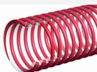
**Structure:** Tuyau flexible fait d'une paroi PVC très souple sans Phtalate de qualité alimentaire selon la norme 10/2011 modifiée (simulants A, B, C, D1) et CE 1935/2004, renforcé d'une spirale en PVC rigide transparent de qualité antichoc.
