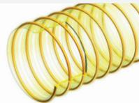
**Structure:** Gaine flexible faite d'une paroi polyuréthane polyéther antistatique R<10<sup>9</sup> Ohm/m souple, renforcée d'une spirale en acier ressort cuivrée pour une mise à la terre. Sans halogènes et sans plastifiants.
