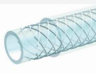
**Structure:** Tuyau flexible fait d'une paroi PVC souple sans phtalate de qualité alimentaire selon la norme 10/2011 modifiée (simulants A, B, C) et CE 1935/2004, renforcé de fils polyester.
