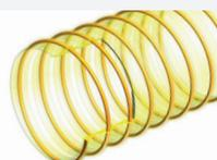
**Structure:** Gaine flexible faite d'une paroi polyuréthane polyéther souple de qualité alimentaire selon la norme 10/2011 modifiée (simulant E) et CE 1935/2004, renforcée d'une spirale en acier ressort cuivrée pour une mise à la terre. Sans halogènes et sans plastifiants.
