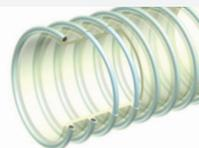
**Structure:** Gaine flexible faite d'une paroi polyuréthane polyéther souple de qualité alimentaire selon la norme CE 1935/2004 et la EU 10/2011 modifiée ainsi que la réglementation FDA-Norme 21 CFR 177.2600 et 178.2010 et antistatique permanent (R<10<sup>9</sup> Ohm), renforcée d'une spirale en inox. INOXX PU 04 FOOD: Paroi 0,4mm. INOXX PU 07 FOOD: Paroi 0,7mm. INOXX PU 14 FOOD: Paroi 1,4mm.
