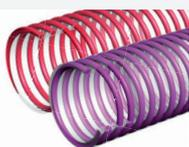
**Structure:** Tuyau flexible fait d'une paroi PVC souple sans Phtalate de qualité alimentaire selon la norme 10/2011 modifiée (simulants A, B, C, D1) et CE 1935/2004, renforcé d'une spirale en PVC rigide de qualité antichoc.
