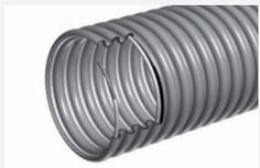
**Structure:** Gaine flexible de poids moyen, faite d'une paroi en PVC souple résistant au feu selon la norme UL94 V0 (en fonction de l'épaisseur de matière – nous consulter), renforcée d'une spirale en acier gainée PVC. Construction spéciale avec une paroi en «vague» pour une flexibilité optimale. Spirale d'acier de mise à la terre.
