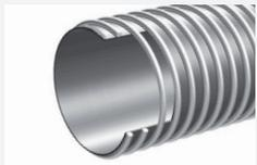
**Structure:** Gaine très flexible et légère faite d'une paroi en PVC souple renforcée d'une spirale en PVC rigide de qualité antichoc. Surface intérieure très lisse.
