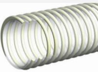
**Structure:** Tuyau flexible fait d'une paroi PVC souple de qualité alimentaire selon la norme 10/2011 modifiée (simulants A, B, C) et CE 1935/2004, renforcé d'une spirale en PVC rigide de qualité antichoc.
