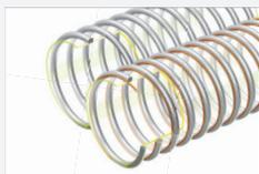
**Structure:** Gaine flexible faite d'une paroi polyuréthane polyéther souple de qualité alimentaire selon la norme 10/2011 modifiée et CE 1935/2004, renforcée d'une spirale en PVC rigide antichoc. Version ANT munie d'une spirale de cuivre pour une mise à terre.
