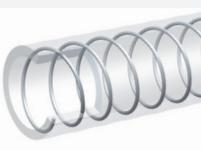
**Structure:** Tuyau flexible fait d'une paroi PVC souple sans phtalate de qualité alimentaire selon la norme 10/2011 modifiée (simulants A, B, C) et CE 1935/2004, renforcé d'une spirale en acier galvanisé.
