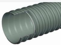
**Structure:** Gaine flexible légère faite d'une paroi en tissu de polyester enduit polyuréthane classée au feu suivant la norme M1, renforcée d'une spirale en acier pour une mise à la terre. Sans halogènes et sans plastifiants.
