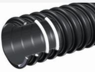
**Structure:** Gaine flexible légère faite d'une paroi en tissu de polyester enduit de TPE, renforcée d'une spirale en PA et protégée d'une bande d'usure TPE.
