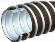
**Structure:** Gaine flexible légère faite d'une paroi en tissu polyester enduit d'Hypalon, et d'un film intérieur en Téflon, renforcée d'un profil en acier galvanisé.
